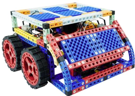
CAGEBOT 科技寶「相撲機器人輕量級車」可搭載市面各類型程控平台，以智慧循跡、自動避障功能，進行激烈碰撞任務，帶領前進機器人知識領域，是一款適合各級學者探索的輪型車。機構採用高強度工業級塑料積木，搭配螺絲固定金屬連接件建造，強調生活科技中手工工具的運用。嚴選齒輪箱大廠-祥儀製造的減速直流馬達，較市面馬達耐磨且穩定性高。
